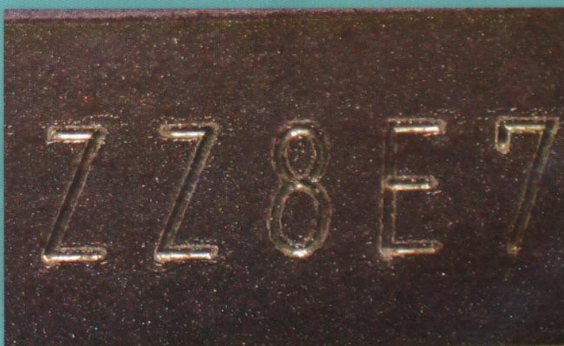
Detail ražby výrobcem. Zde, například u písmena E, je vidět, jak byl tento znak vyroben. Rytí začalo vpravo nahoře a bylo vytvořeno písmeno C a při druhém kroku byla vyryta prostřední část znaku. Dráhu rycího trnu lze sledovat i u číslice 8.
